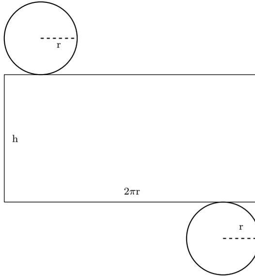
Puesto que el volumen ( $V$ ) es 2 litros, consideramos entonces que el  $V = 2l = 2 \text{ dm}^3$ . Sabemos que el volumen del cilindro es el área de la base,  $\pi r^2$ , por la altura  $h$ ; para  $r$  y  $h$  en decímetros.
