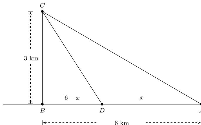
Pensemos que vamos a llevar la tubería desde  $A$  hasta  $D$ , un punto sobre la playa a  $x$  km de  $A$ , y de ahí a  $C$  por el mar; la distancia  $CD$ , como hipotenusa de un triángulo rectángulo con vértice en  $B$  es
